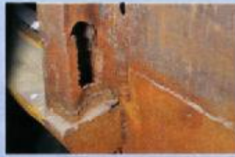
Schwellerende und A-Säule liegen im Spritzwasser der Vorderräder
