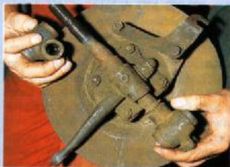
Wehe, wenn da nicht geschmiert wird: Der Achsschenkel dreht sich in simplen Gewinden
