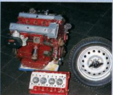
Die Insignien des Twin Cam: Zentralverschluss und Zylinderkopf mit Halbkugel-Brennräumen
