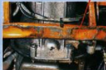
Die Rahmentraverse ist ein echter Tiefpunkt – und oft verzogen
