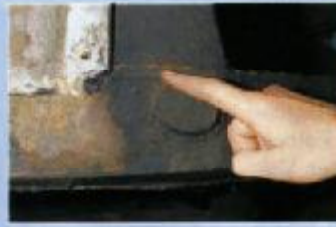
Der Übergang vom Rahmen zur A-Säule rostet beinahe unbemerkt
