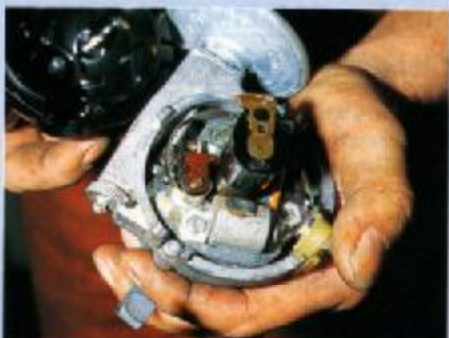
Ausgeschlagene Verteiler sorgen für unruhigen Leerlauf und Leistungsschwächen
