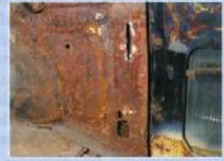
Türrahmen und B-Säule sind bei diesem Coupé schwer angegriffen
